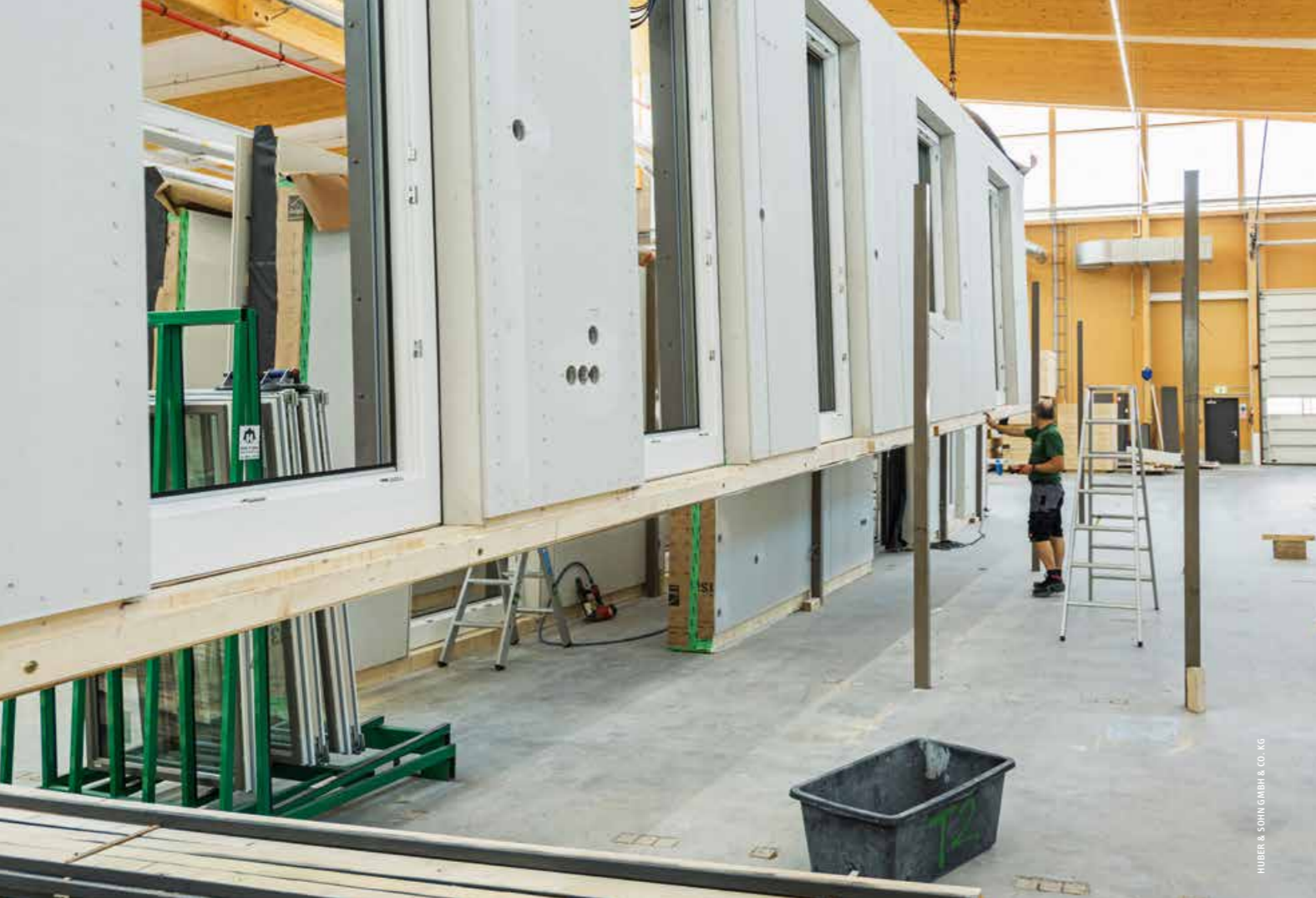
▲ Sämtliche Fensterelemente wurden schon im Werk eingebaut
